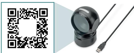
**2D-Barcode-Scanner** lesen komplexere Codes, die aus Punkten oder kleinen Quadraten zusammengesetzt sind (QR-Codes, PDF14, Datamatrix). Diese vertikalen und horizontalen Muster haben eine höhere Informationsdichte.
